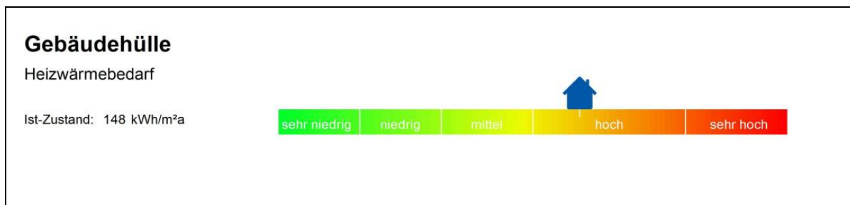
Abbildung 61: Der Heizwärmebedarf der Baualterklasse VII im Ist-Zustand
